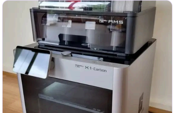
CoreXY fechada com AMS. O cabeçote voa em X/Y e a mesa só desce. Bambu Lab X1 Carbon · foto: Benlisquare, CC BY-SA 4.0
