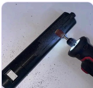
Microrretífica lixando uma peça · foto: Tanman21, CCO
