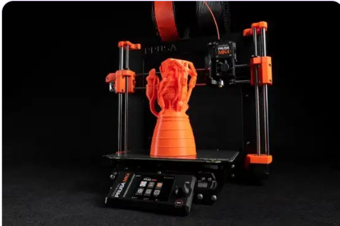
Mesa móvel (bed slinger). A mesa corre para frente e para trás embaixo do bico. Prusa MK4 · foto: Majkluss, CC BY-SA 4.0
